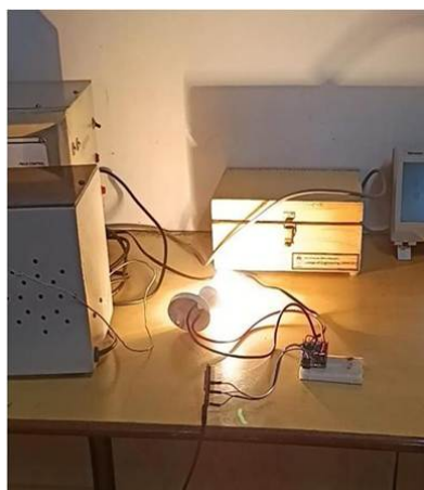
Fig. 5: AC load parameters monitoring
